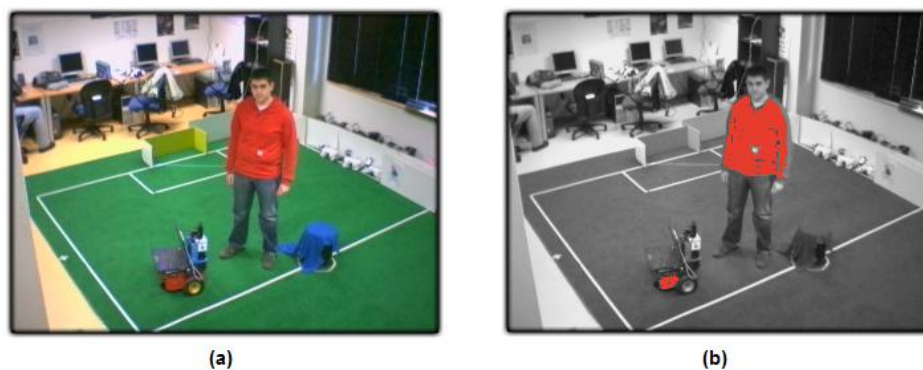
Figura 4.8: Filtro de color para rojo - Imagen sin filtrar (a) Imagen filtrada (b).
