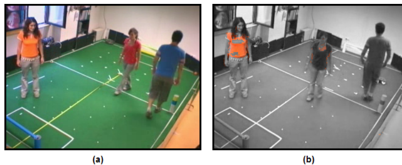
Figura 5.11: Filtro mediante histograma de H - Imagen sin filtrar (a) y filtrada (b).
