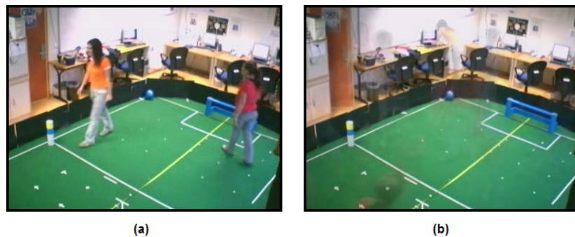
Figura 5.14: Fondo aprendido-Imagen instantánea (a), imagen de fondo aprendida (b)
